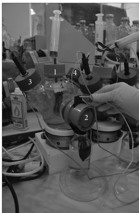
Рис. 3. Разработанный лабораторный прототип МТЭ для скрининга и культивирования сообществ и чистых культур электрохимически активных микроорганизмов. 1 – анодная камера; 2 – катодная камера; 3 – рН электрод; 4 – электрод сравнения
